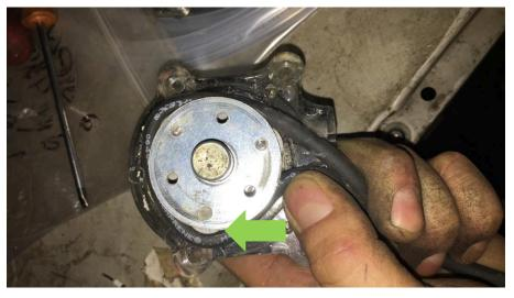
3. SECURE THE PUMP SCREWS TO THE MOTOR. HAND TIGHT. BE CAREFUL TO NO PINCH THE TUBING OUTSIDE OF THE TRACK
