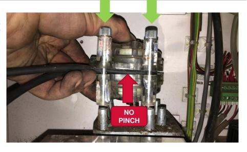
2. PULL THE TUBING TIGHT AND BRING TOGETHER THE PUMP HEAD HALVES.
